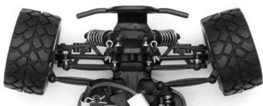
Übertriebene Einstellung der Vorspur (nie so stark einstellen!)
