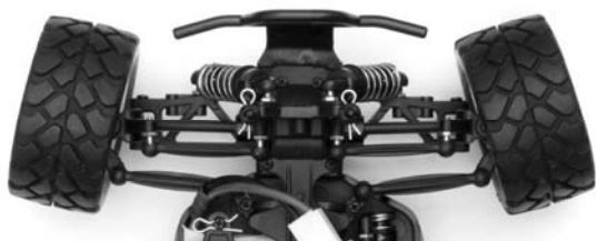
Paramètre de pincement exagéré (Ne pas le faire souvent!)
