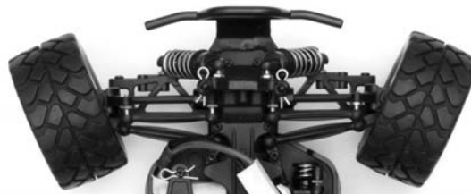
Ajuste de divergencia exagerada (¡nunca llegue a este extremo!)
