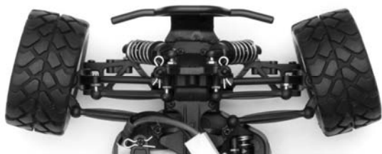
Ajuste de convergencia exagerada (¡nunca llegue a este extremo!)
