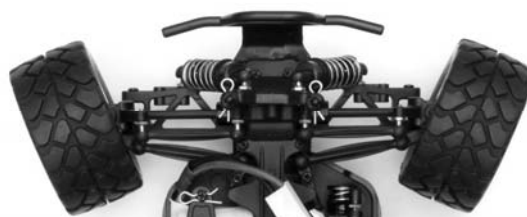
Übertriebene Einstellung der Nachspur (nie so stark einstellen!)
